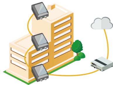
高層ビルのヘルスマニタリング
