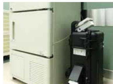
大容量ポータブル式のリチウムイオン蓄電池
